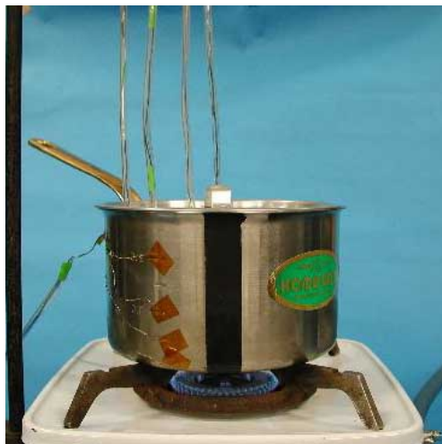
Fig. 2.15: 熱電対を貼り付けた鍋
