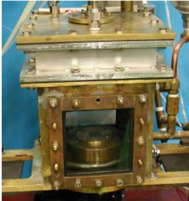
Fig. 3.2 Boiling cell.
