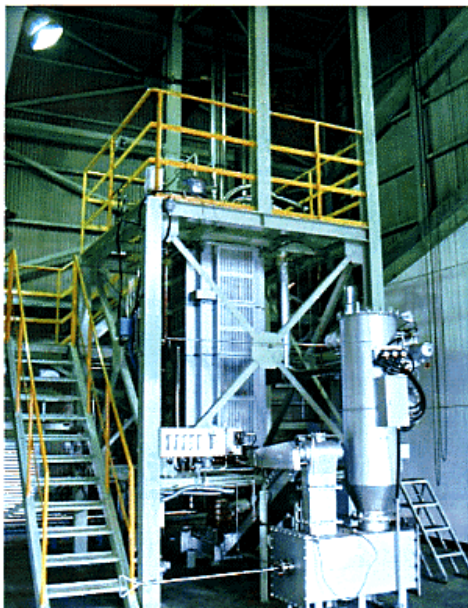
カーボンナノチューブ大量合成装置 (昭和電工生産技術センター内)
