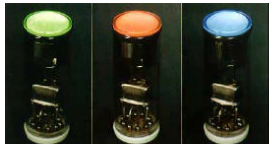
Fig.1-9 カーボンナノチューブ冷陰極を用いた 高電圧型蛍光表示管 (伊勢電子工業)
