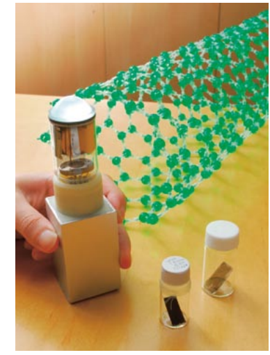
カーボンナノチューブの構造モデル(奥)と、ノリタケ伊勢電子株式会社の電子エミッター(手前左)。手前右はカーボンナノチューブ膜付きの基板
